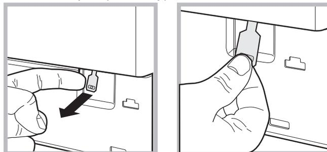
4. потяните наружу язычок, показанный на схеме, вплоть до освобождения пластикового блокировочного винта. Затем потяните его вниз и одновременно откройте люка.
